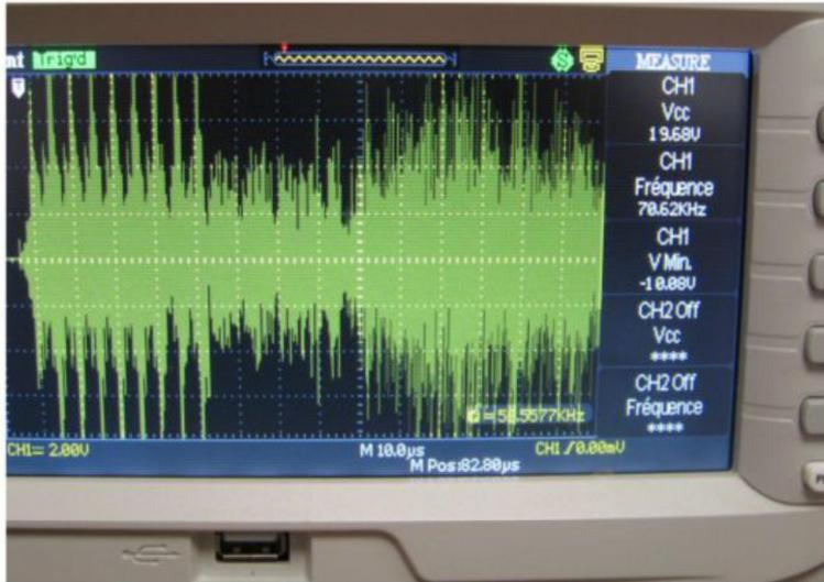
Amplitudes d'un bloc d'émission CPL radiofréquences plug numérique courant porteur ligne 20MHz transporté par le réseau électrique d'un Logement ABSOPLUG ALPHA connecté.
